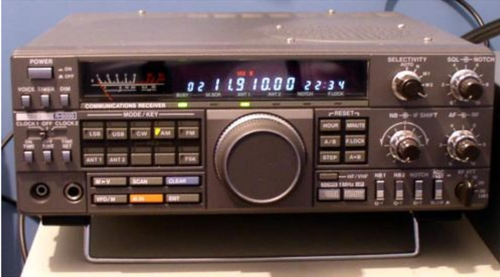
Las salidas del receptor R5000 son nivel TTL, pero para interactuar con el puerto serie o USB del PC, se requiere convertir los 0-5 V en RS232 o USB mediante un convertor.
