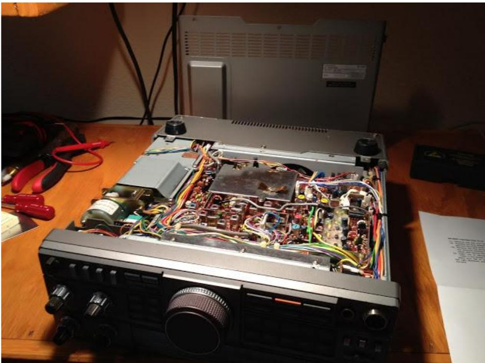
Después quitar los tres tornillos en la parte inferior de la pantalla (parte de plata a la derecha con los tres orificios). También quitar los cuatro tornillos (dos a cada lado) que sujetan el panel frontal en su lugar:
